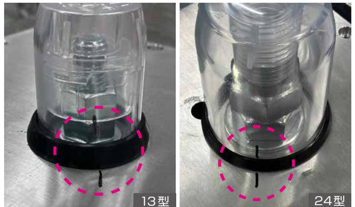
JIS E 3014 3種A種の試験後、合いマークのずれなし。
