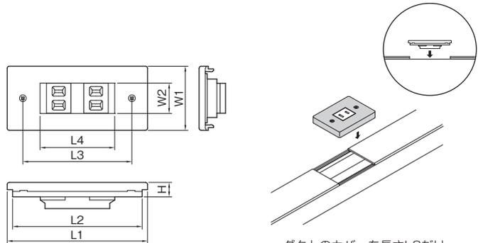
ダクトのカバーを長さL2だけ切断し、ダクトのベースにはめ込みます。
