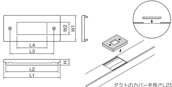
ダクトのカバーを長さL2だけ切断し、ダクトのベースにはめ込みます。
